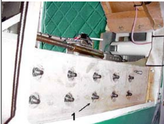
1 da sotto la fusoliera montare rondelle e dadi sulle viti passanti e stringere
