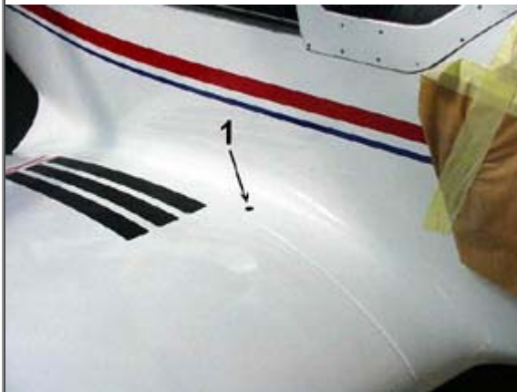
1 foro per passaggio vite M8 x 240
